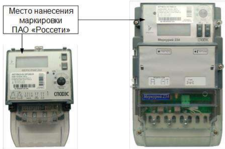
Рисунок 2.7 – Место нанесения маркировки ПАО «Россети»
