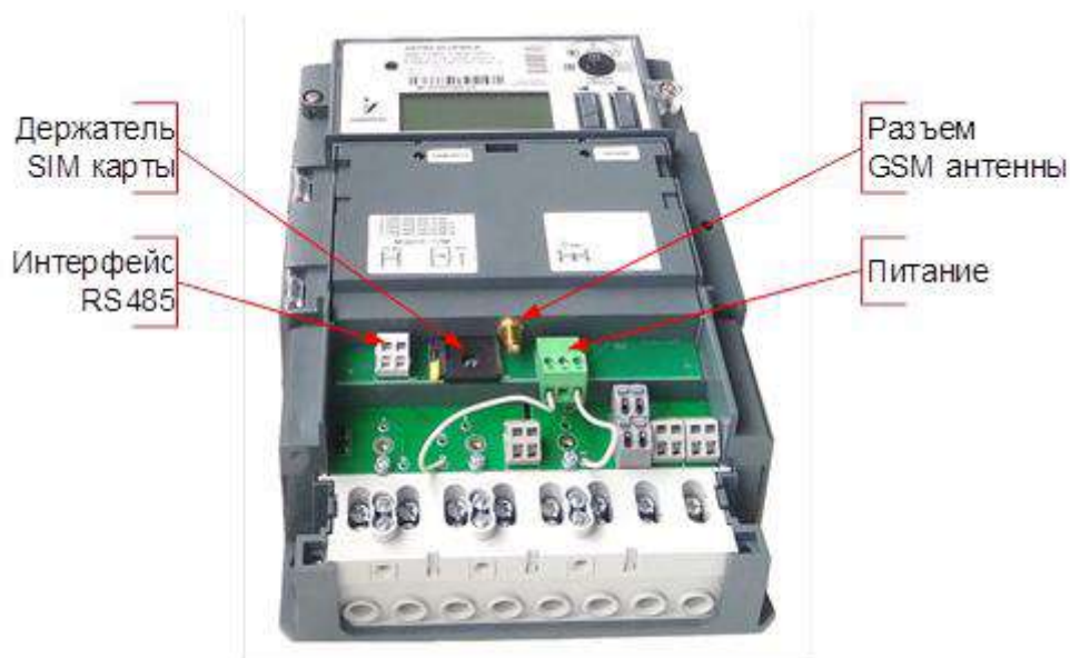
Рисунок 4.8 – Элементы подключения модуля GSM
