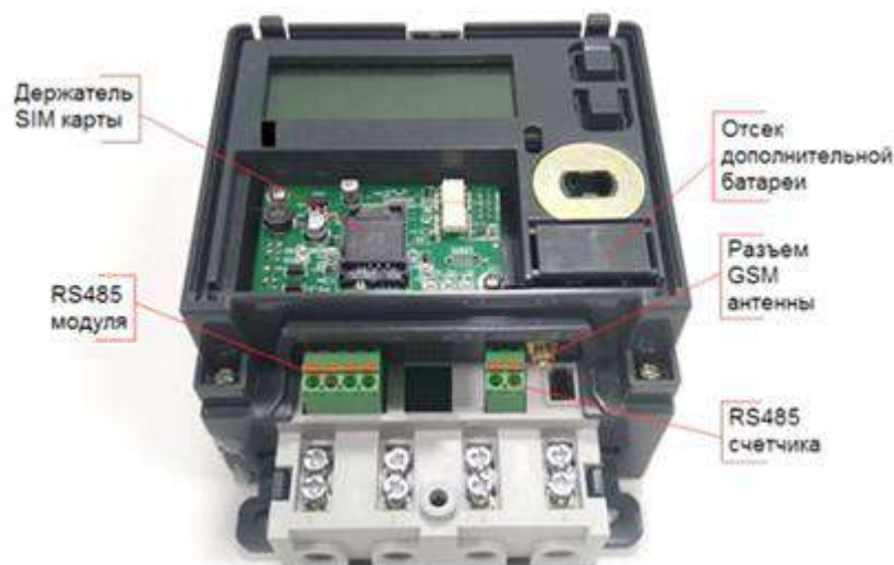
Рисунок 4.4 – Элементы подключения счетчика «Меркурий 204»
