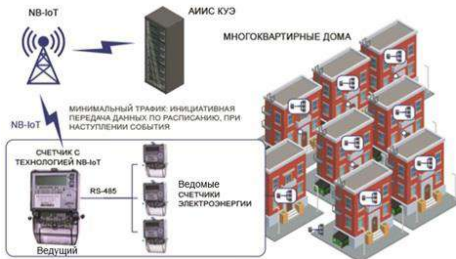
Рисунок 3.5 – Схема работы счетчика NB-IoT в составе АИИС КУЭ
