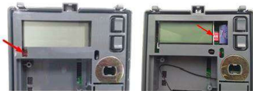
Рисунок 3.1 – Расположение переключателя блокировки управления нагрузкой счетчика «Меркурий 204»
