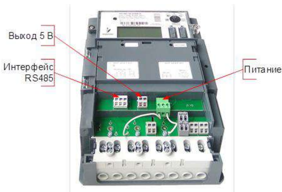
Рисунок 4.7 – Элементы подключения модуля RS485
