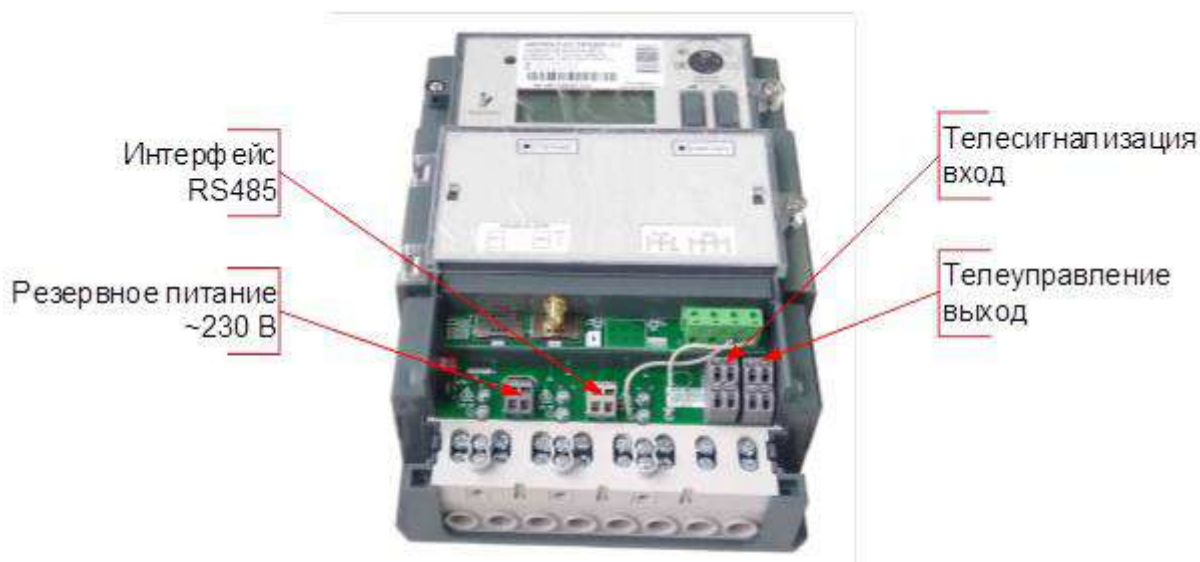
Рисунок 4.5 – Элементы подключения счетчика «Меркурий 234» с индексом «Х»
